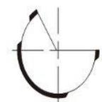
高いバニッシング性により、アルミ合金や真鍮の加工で、高い面粗度が得られます、クロス穴や断続加工にも向いています。耐熱合金などの難削材では使用できません。
