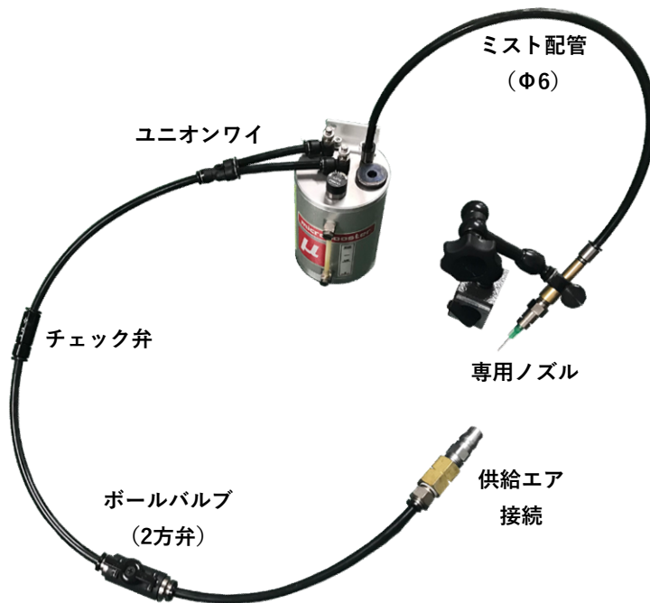
MicroBoosterのエア配管図
