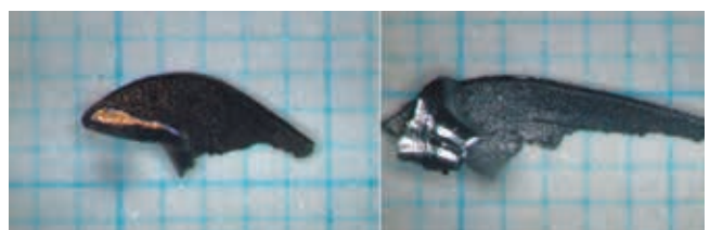
【写真2】左：セミドライ加工 右：水溶性切削油の切り屑 出典：(株)不二越
