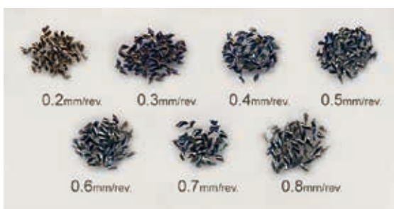
【写真3】 MQL加工時の超硬ロングドリルの送りを変化させたときの切り屑形状の写真。 どの送りの場合も小さくカールし、排出に優れた形状をしている。
